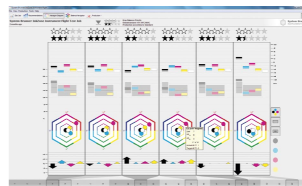
Fig. 3b) Diagrama hexagonal com informações L*a*b* e sistema de avaliação da qualidade 5 estrelas num só
