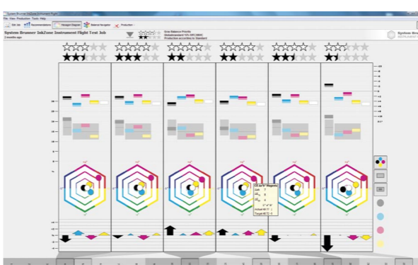
III. 3b) Diagrammes Hexagone avec d'un seul coup d'œil les informations L*a*b* et l'appréciation de la qualité 5-étoiles
