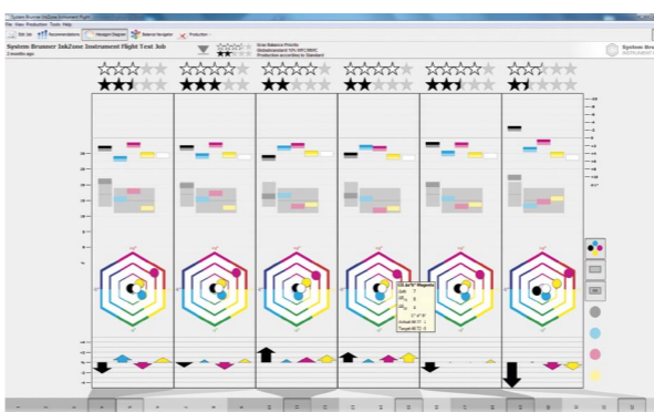
Abb. 3b) Hexagon Diagramme mit L*a*b* Informationen und 5-Sterne Qualitätsbeurteilung auf einen Blick
