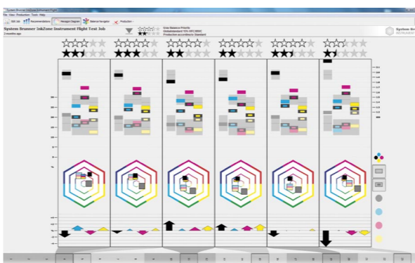
Abb. 3a) Hexagon Diagramme mit 5-Sterne Qualitätsbeurteilung und Prozess-Diagnostik auf einen Blick
