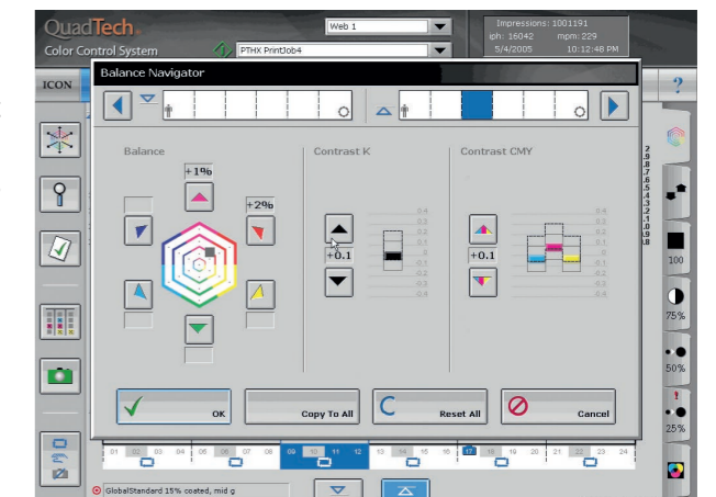
III. 4) Balance Navigator® pour des corrections chromatiques rapides et prévisibles en boucle de régulation fermée
